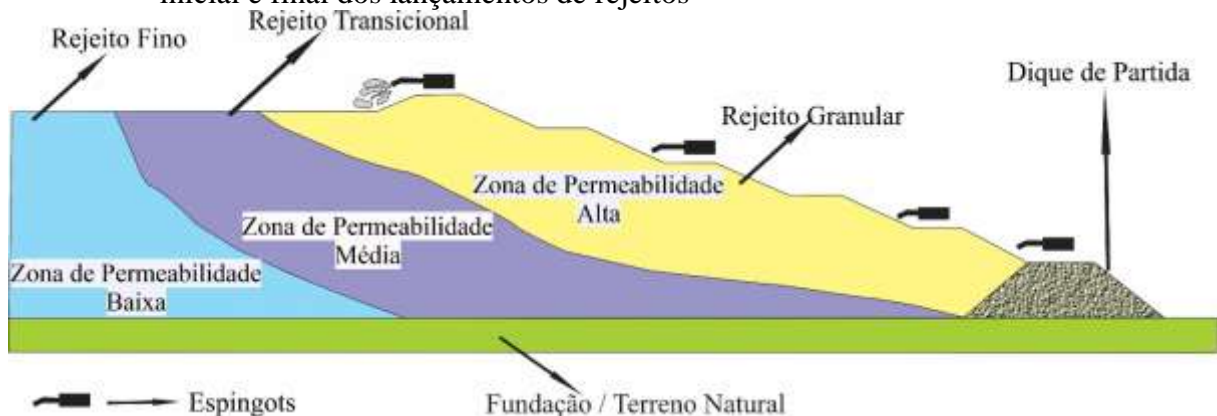
Figura 23 – Configuração esquemática de permeabilidade dos rejeitos considerando o ponto inicial e final dos lançamentos de rejeitos
