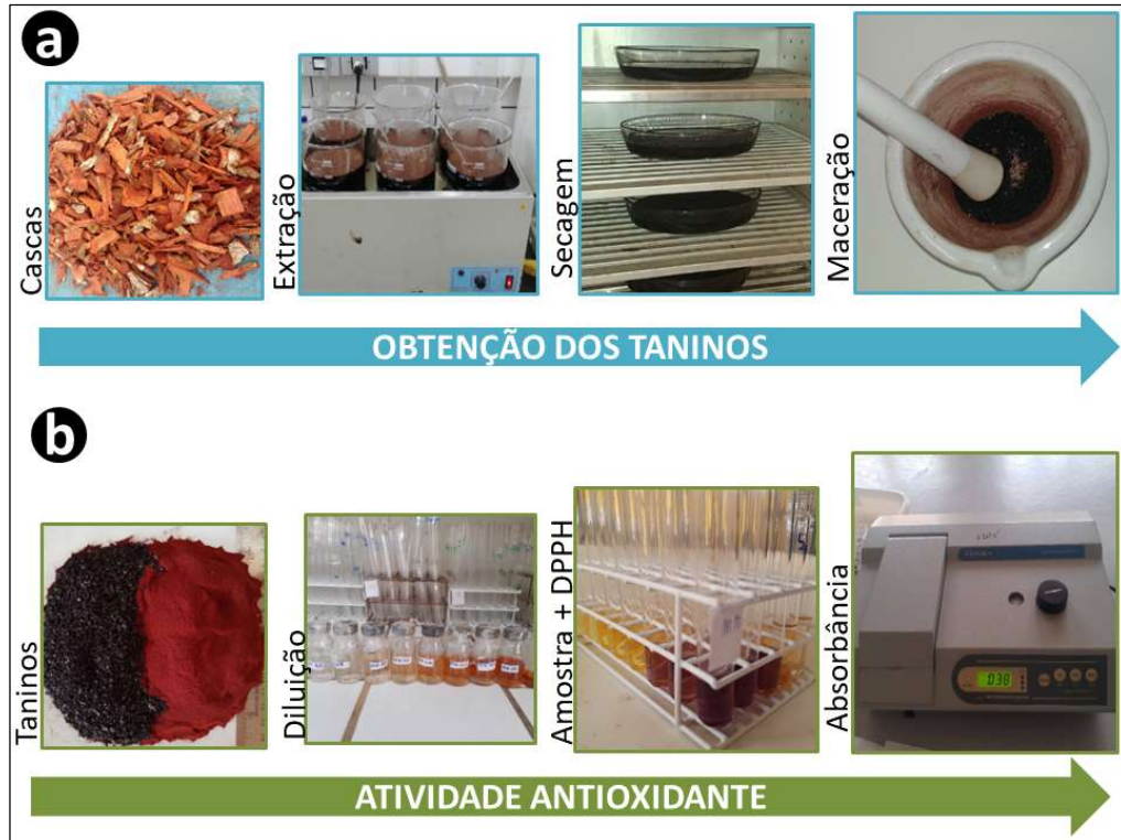
Figura 2. Principais etapas da análise de antioxidante. (a) Processo de obtenção dos taninos. (b) Análise antioxidante dos compostos.
