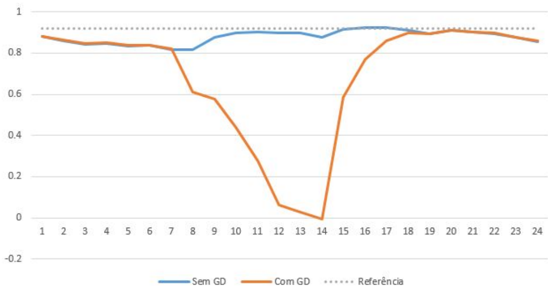
Figura 3.37 – Cenário D: Fator de Potência com Demanda Máxima com e sem GD
