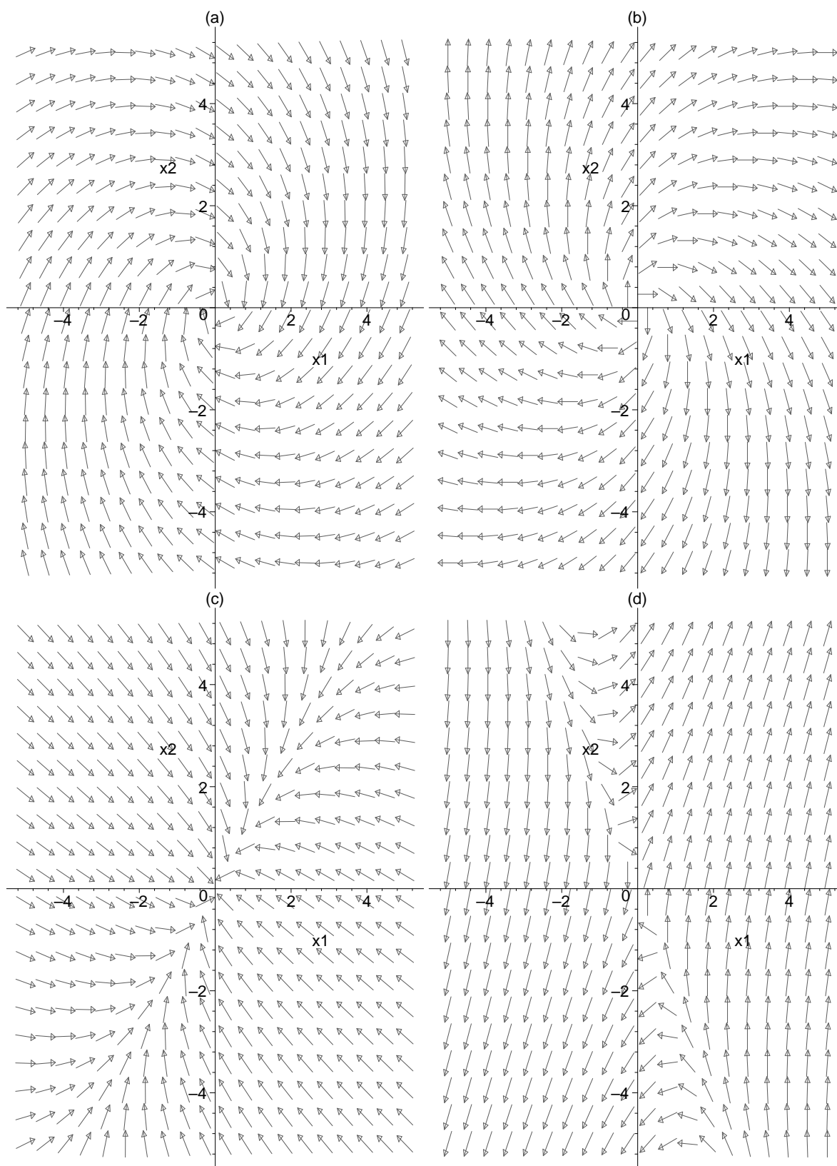
Figura 3.1: Ilustração de trajetórias. (a) Ponto espiral assintoticamente estável. (b) Ponto espiral instável. (c) Nó assintoticamente estável. (d) Nó instável.
