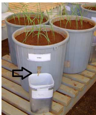
Figura 2 Detalhe do coletor de lixiviado. Lavras-MG, 2013
