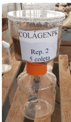
Figura 1 Detalhe do funil de lixiviação com o substrato arenoso. Lavras-MG, 2013
