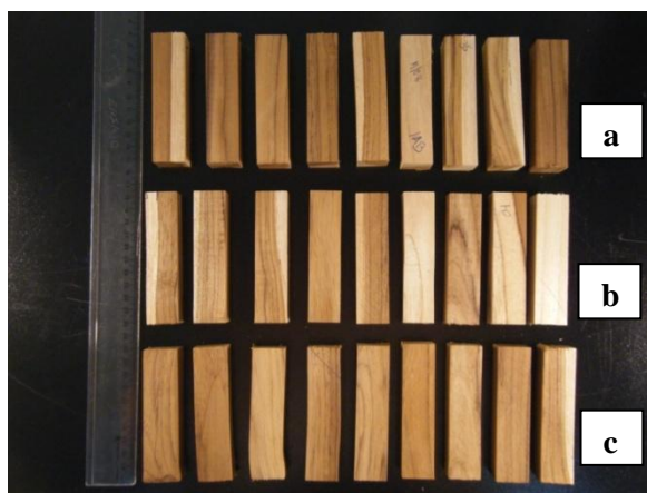
Figura 17 Tipos de ruptura na compressão paralela às fibras.
