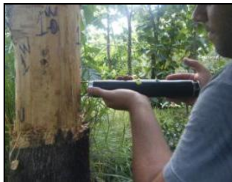
Figura 7 Aparelho Pilodyn® para avaliação não destrutiva na teca.
