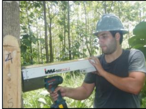
Figura 6 Detalhe do Resistograph® para avaliação não destrutiva na teca.
