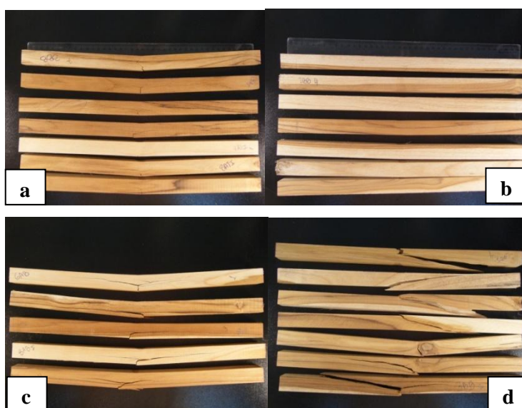
Figura 16 a, b, c, d - Tipos de ruptura no ensaio de flexão estática.
