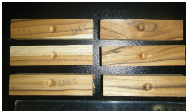
Figura 18 Tipos de depressão na madeira pelo ensaio de dureza Janka.
