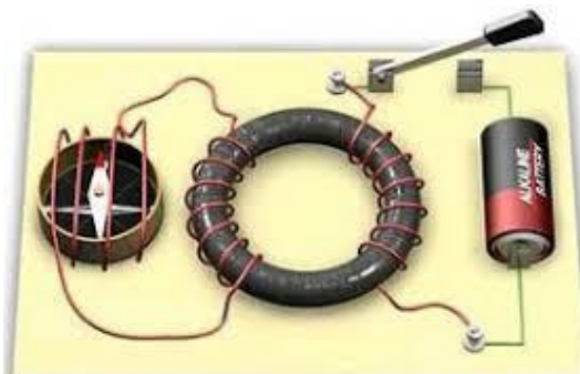
Figura 2 – Materiais utilizados por Michael Faraday em seus experimentos. (a) desenho que tenta reproduzir os objetos da forma como eram em 1831. (b) desenho que ilustra uma montagem do experimento utilizando versões mais modernas dos equipamentos.
