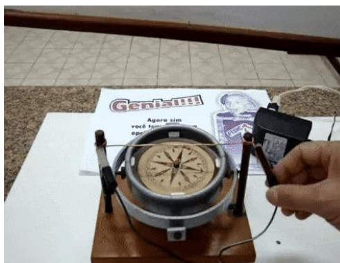
Figura 1 – instantâneo retirado de um vídeo sobre o experimento de Öersted.
