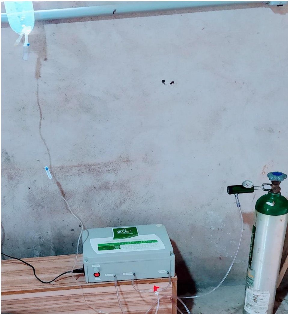
Figura 7 – Equipamento gerador de ozônio
