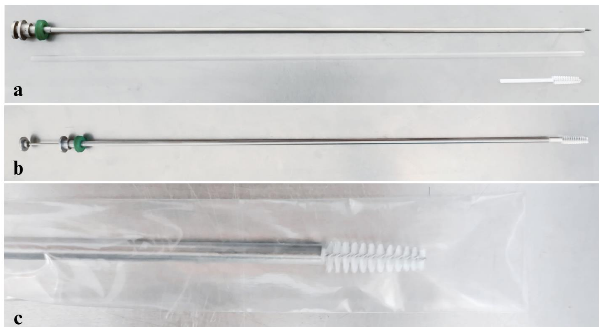
Figura 5 – Montagem do equipamento utilizado para citologia endometrial bovina
