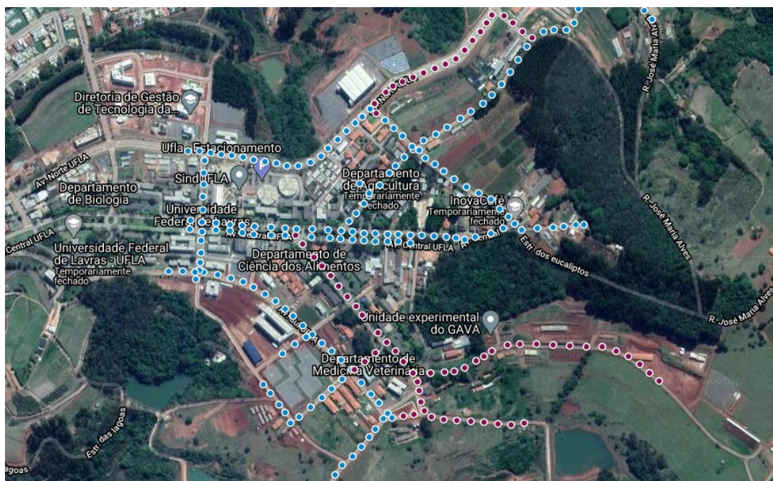
Figura 5.5 – Representação dos trechos com cabos de 150mm 2 e 50mm 2
