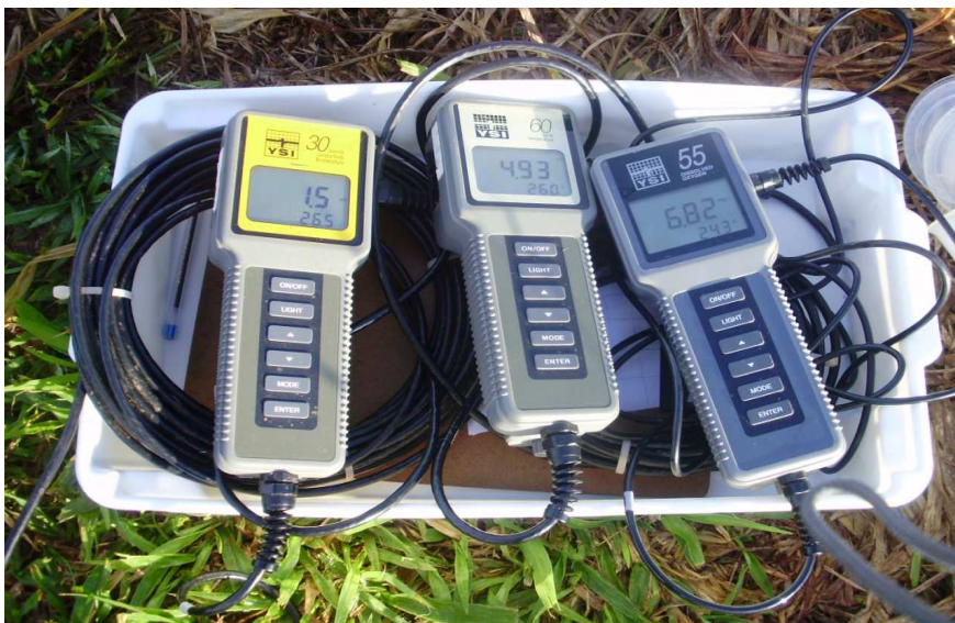
Figura 4 Sensores analógicos YSI utilizados para obtenção das variáveis físicas e químicas (pH, temperatura, concentração de oxigênio dissolvido e condutividade elétrica)
