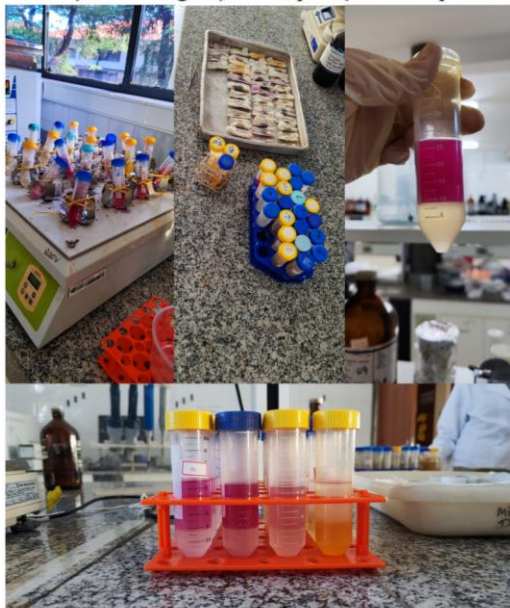
Extração com agitação e separação dos lipídeos.
