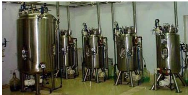
Figura 3 Exemplo de uma instalação industrial para a produção massal de células de rizóbios com fermentadores menores acoplados
