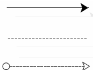
Figura 2.7 - Respectivamente segundo a notação BPMN, Fluxo de seqüência, Associação e Fluxo de mensagem
