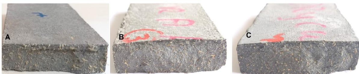
Figura 11. Análise visual de ruptura dos corpos de prova de fibrocimento extrudado
