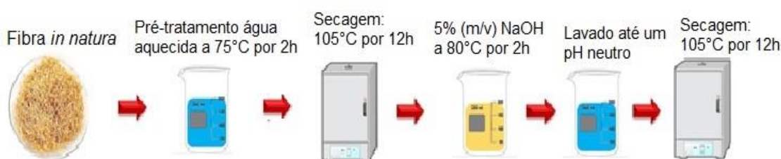
Figura 1 – Esquema da preparação das fibras tratadas com solução de hidróxido de sódio.
