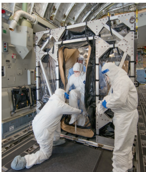
Figura 2.8 – Sistema de isolamento e transporte TIS.
