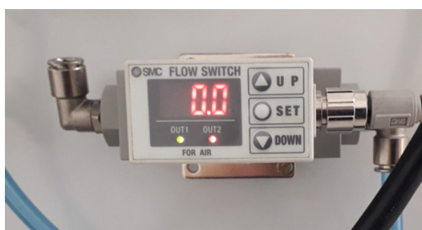
Figura 3.8 – Controlador de vazão.
