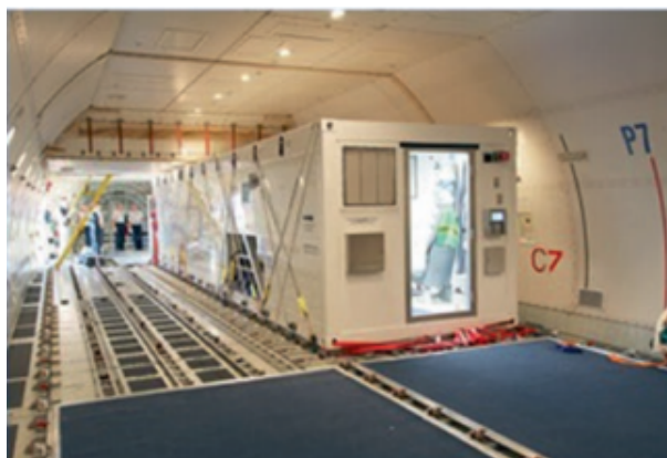
Figura 2.9 – Sistema de biocontenção em contêiner CBCS.
