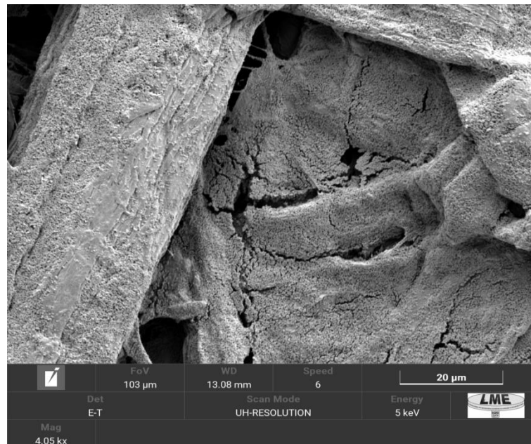
Figura 16 - Nanopartículas de lignina Kraft aderidas às microfibrilas do papel.
