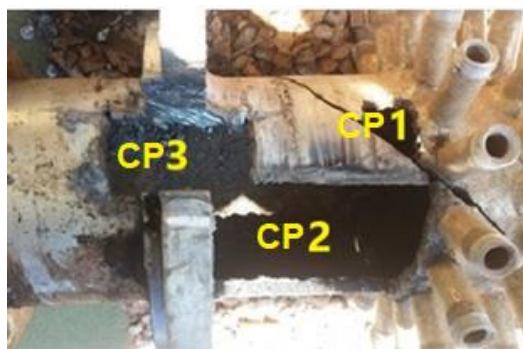
141 Figura 4- Retirada de CPs para análises (CP1) de fratura, (CP2) químicas e de tração, (CP3) da junta soldada 142
