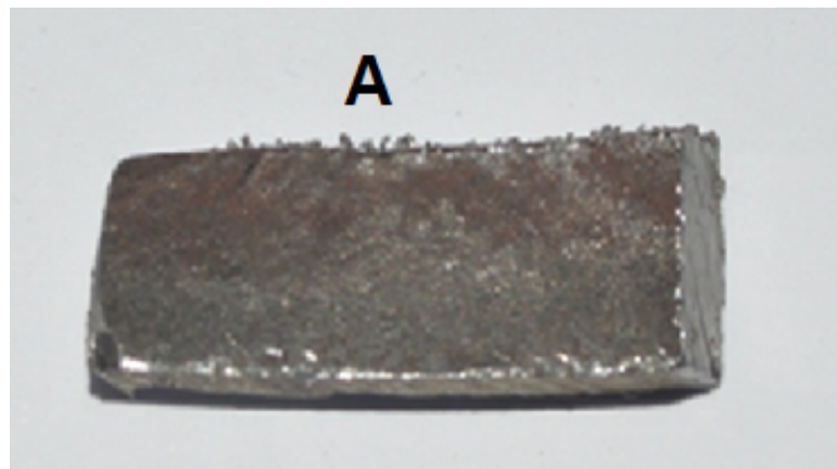
Figura 4.9 – Região do cilindro de varetas vibrador fraturada para análise MEV.
