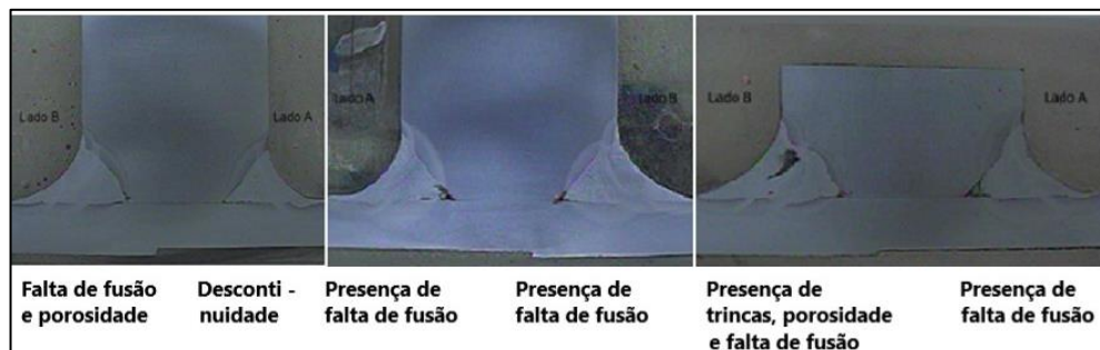
Figura 16 - Ataque com ácido nital 10% para revelação da solda Fonte: Dos autores (2018).
