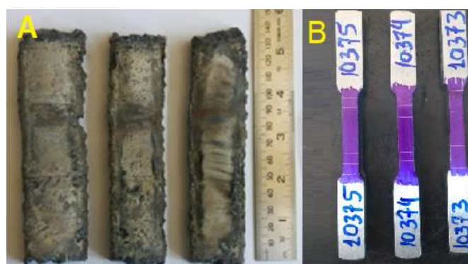
Figura 7 - Preparação dos blanks (A) e confecção dos CPs (B) para ensaio de tração.
