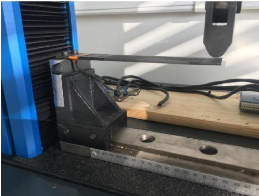
Figura 5 - Implemento com viga metálica engastada
