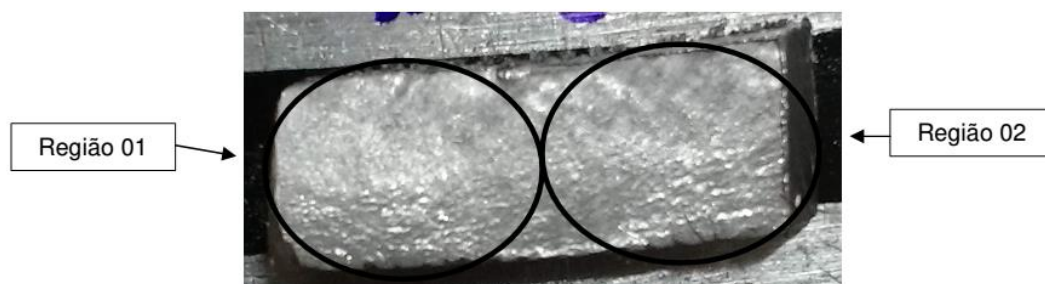
Figura 9 - Regiões de fratura submetidas à análise MEV
