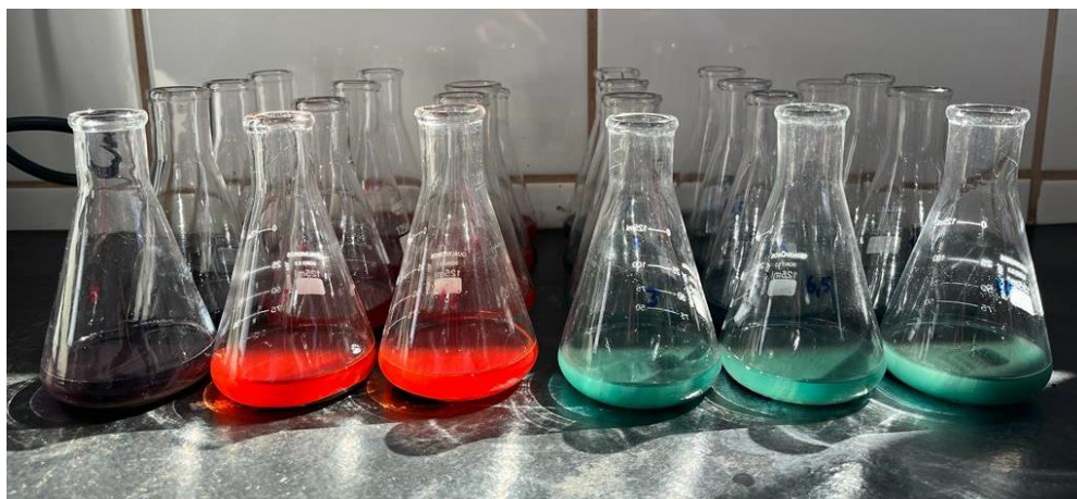
Figura 27. Soluções de vermelho do congo e azul de metileno nos pH 3, 5 e 6,5, respectivamente.
