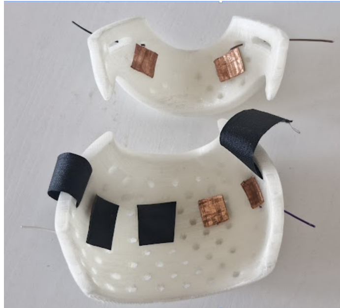
Fig. 3.7: Capacete ortopédico impresso em 3D - montagem parcial (Elaboração própria).
