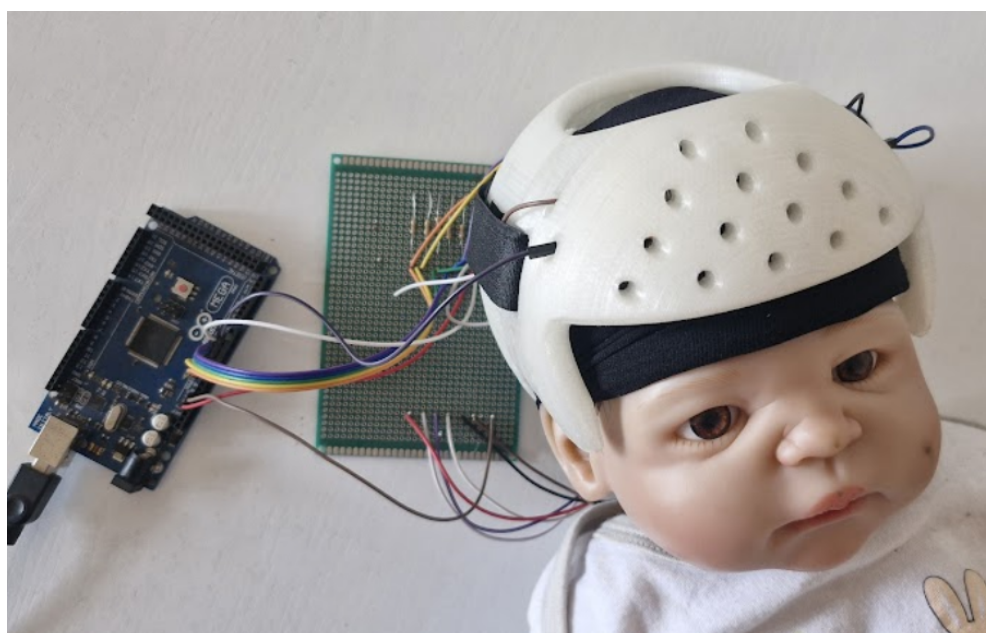
Fig. 3.9: Manequim com protótipo da órtese (Elaboração própria).
