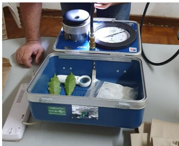
Figura 3 - Medição do \Psi_w pela bomba de Scholander
