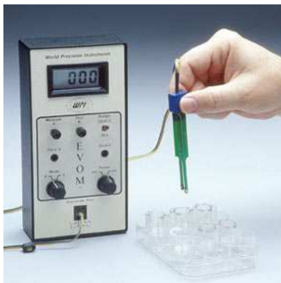
Figura 2 Aparelho Epithelial volt ohmmeter , EVOM (World Precision Instruments, Inc.) utilizado para as avaliações da TEER de linhagens celulares
