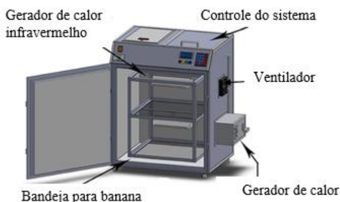
Figura 6: Protótipo de secador híbrido com secagem convectiva com ar quente e infravermelha.
