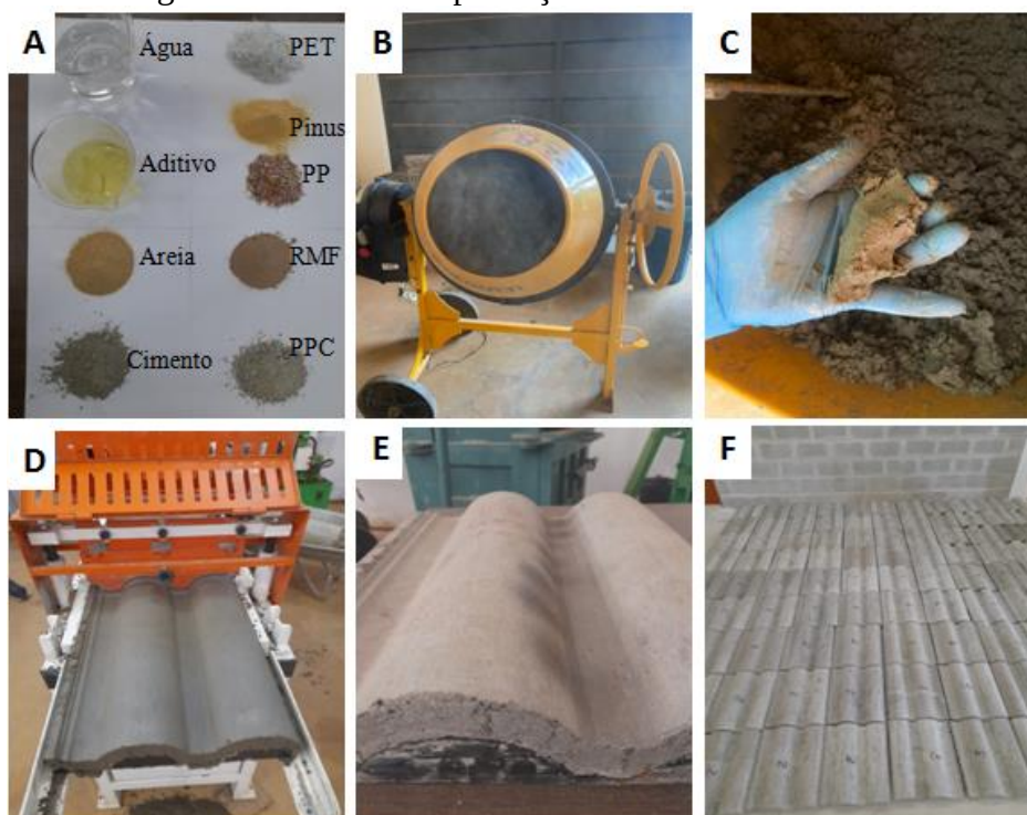
Figura 2 - Processo de produção das telhas de concreto.
