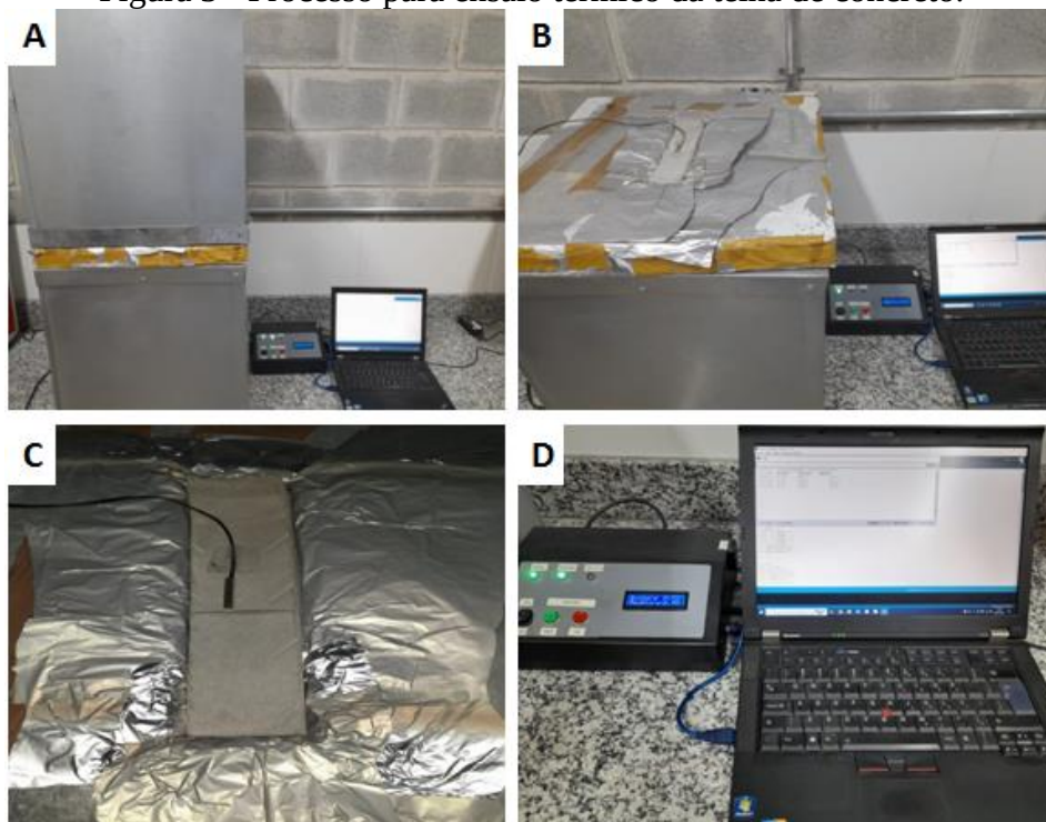
Figura 3 - Processo para ensaio térmico da telha de concreto.
