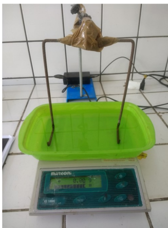
Figura 4.3 – Representação esquemática do sistema para obtenção da massa imersa.
