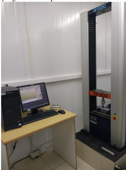
Figura 4.4 – Representação gráfica da máquina de teste universal utilizada no ensaio mecânico.
