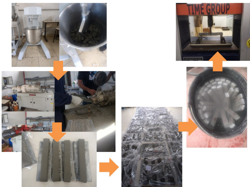
Figura 4.1 – Ilustração das etapas do processo utilizado na produção dos fibrocimentos.
