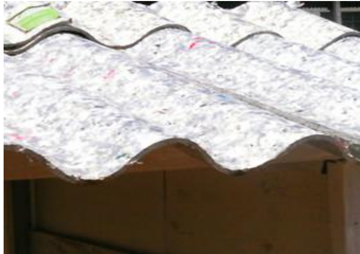
Figura 5 Telha de material reciclado formada a partir de embalagens Tetra Pak ®
