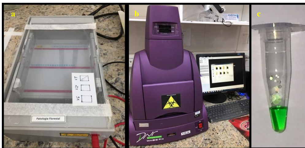
Figura 4: a- Cuba de eletroforese, utilizando; b- Fotodocumentador de luz ultravioleta DNR Bio-Imaging Systems MiniBis Pro; c- DNA enviado a Macrogen.
