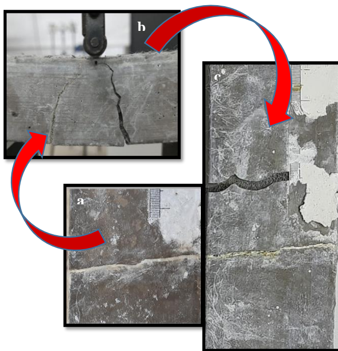
Figura 15: Imagem de 1 cp que teve propagação o de fissuras em ponto adverso a fissura inicial.
