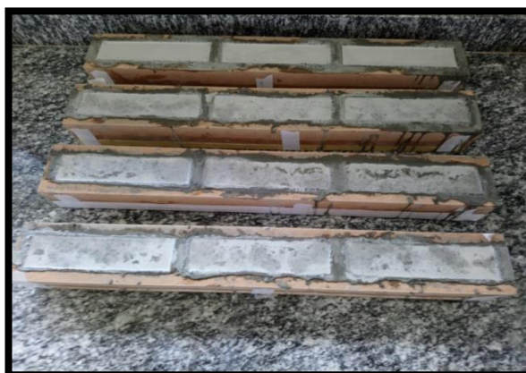
Figura 3: Corpos de prova de pasta de cimento 60mm x 40mm x 40mm.
