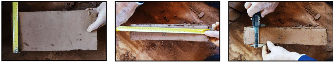
Figura 2 – Representação esquemática da obtenção das medidas das dimensões dos adobes.
