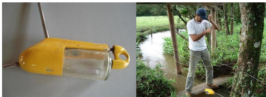
Figura 13 Amostrador de sedimentos USDH-48 e momento da amostragem na bacia hidrográfica do ribeirão Lavrinha.
