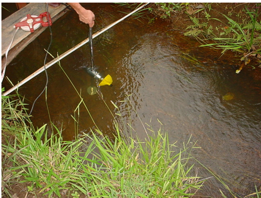
Figura 12 Medição de velocidade com molinete na seção de controle da bacia hidrográfica do ribeirão Lavrinha.
