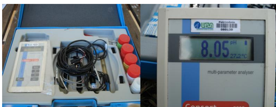
Figura 14 Aparelho portátil CONSORT C535 utilizado para monitoramento da qualidade da água na bacia hidrográfica do ribeirão Lavrinha.
