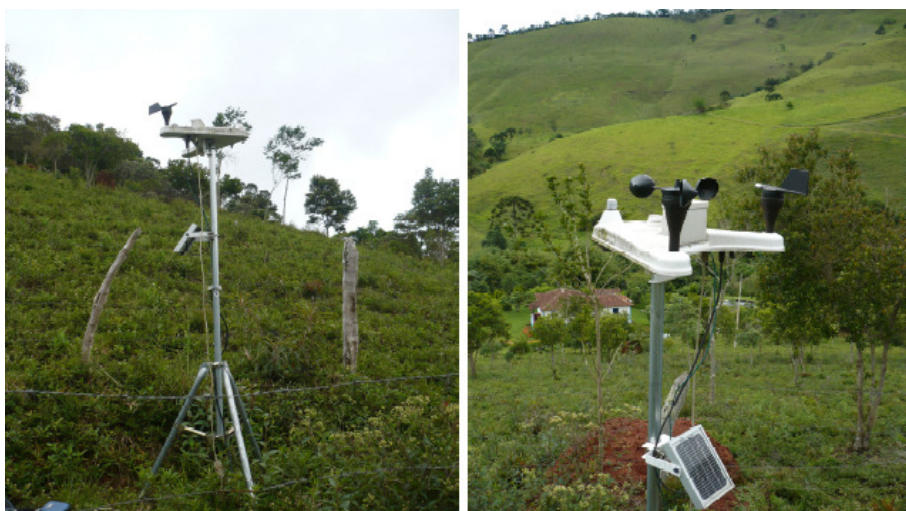
Figura 9 Estação climatológica da bacia hidrográfica do ribeirão Lavrinha.
