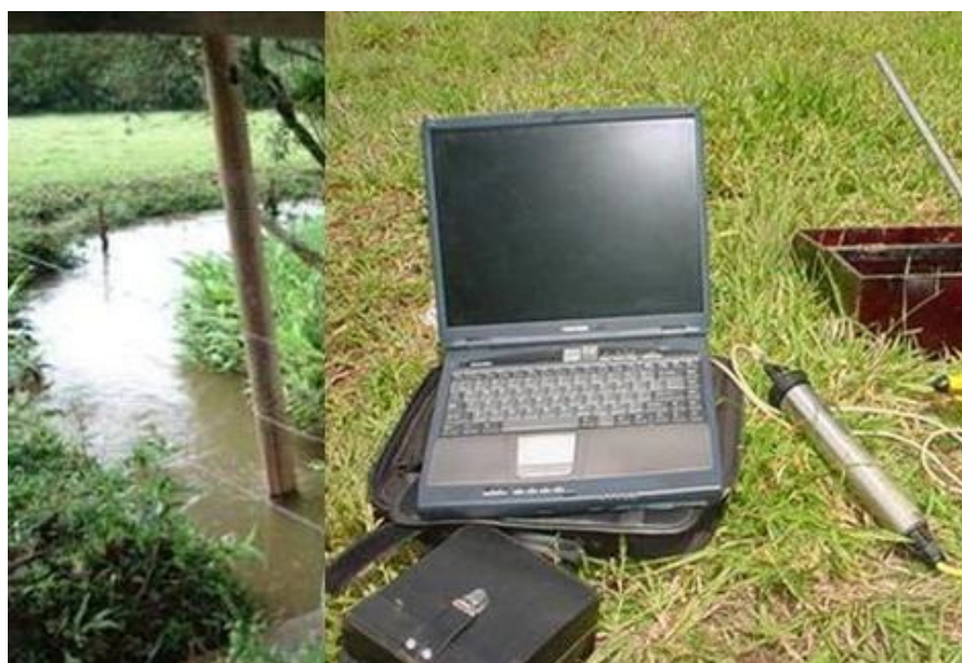
Figura 11 Linígrafo instalado na seção controle da bacia hidrográfica do ribeirão Lavrinha e data logger sendo descarregado.
