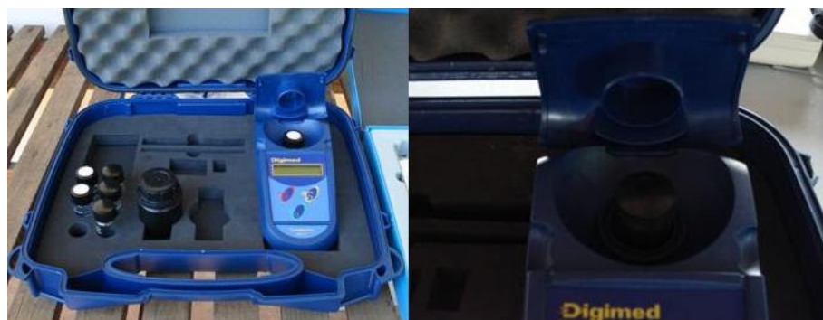
Figura 15 Turbidímetro digital modelo DIGIMED DM-TU.
