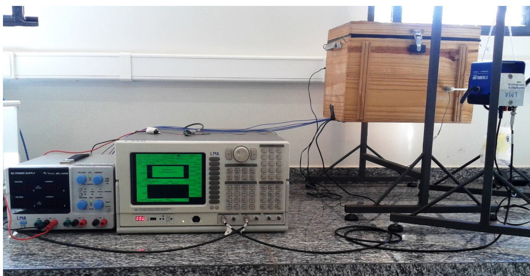
Figura 3.18 – Configuração experimental para a análise FRF.
