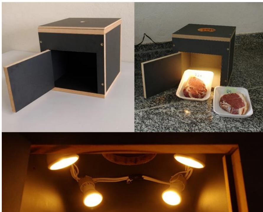
Figura 1. Fotografias do estúdio fotográfico e disposição da iluminação por lâmpadas LEDs.
