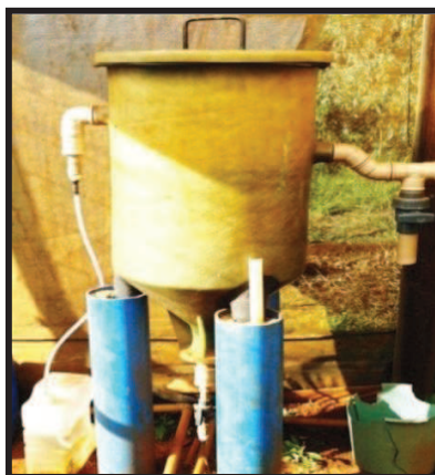
Figura 8 Filtro anaeróbico utilizado no experimento no tratamento de efluente de suinocultura.
