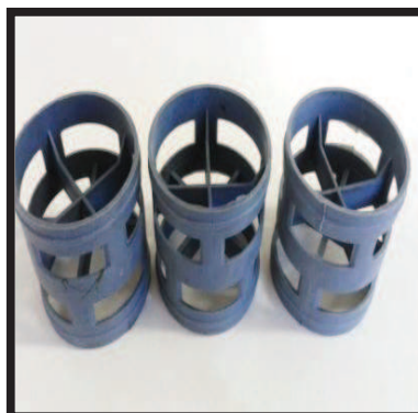
Figura 9 Unidade do meio suporte empregado no FA para adesão de biofilme
