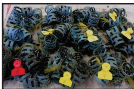
Figura 10 Meio suporte identificados em rede com biofilme aderido ao final do experimento
