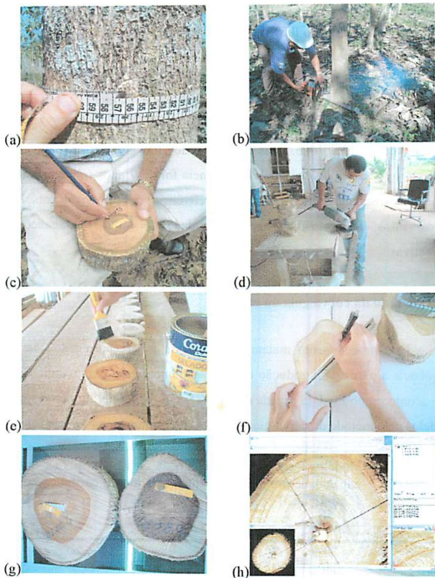
FIGURA 3.1 (a) Identificação das árvores dominantes; (b) abate das árvores (c) codificação dos discos; (d) lixamento dos discos; (e) aplicação de resina; (f) marcação das linhas referenciais de mensuração dos anéis de crescimento; (g) digitalização dos discos; e, (h) processamento das imagens e mensuração dos discos de teca
