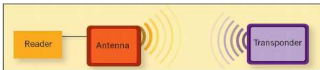
Figura 3.1 – Arquitetura básica RFID
