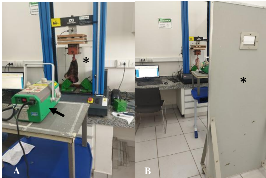
Figura 4 – Posicionamento do aparelho radiográfico e biombo no ensaio mecânico. A – Aparelho radiográfico (seta) colocado sobre bancada e posicionado em frente ao membro fixo à máquina. Cassete radiográfico posicionado logo atrás do membro (*). B – Biombo posicionado para proteção radiológica (*).
