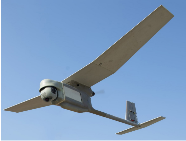
Figura 150: Câmeras EO/IR giro-estabilizadas do VANT RQ-11B Raven.
