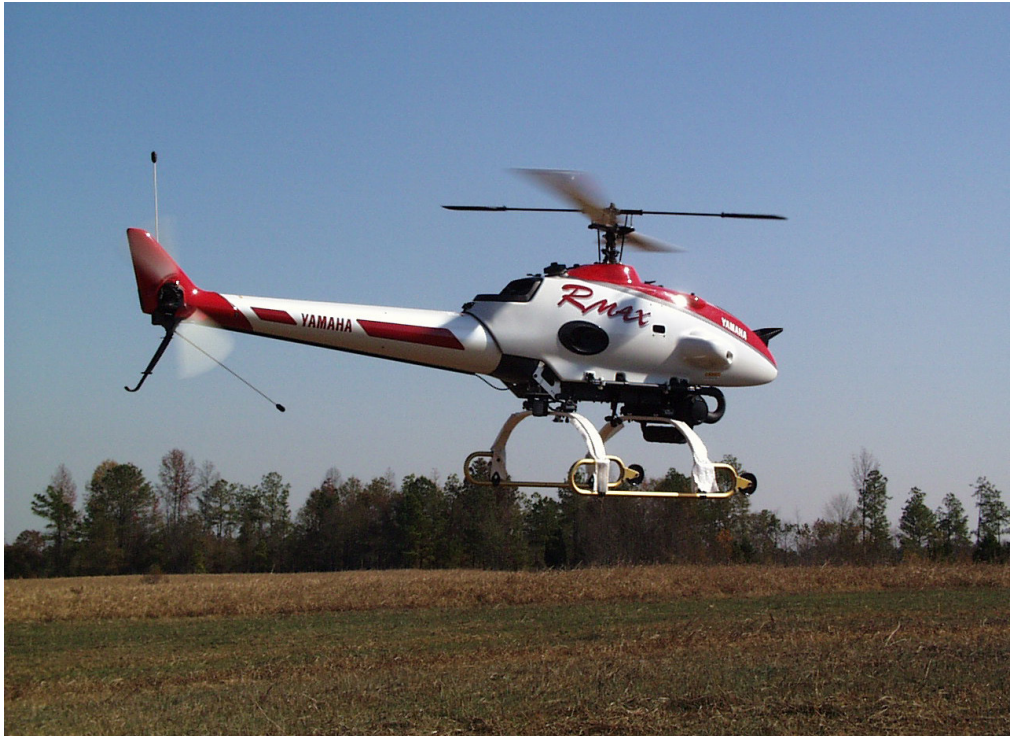
Figura 71: Helicóptero não-tripulado RMAX da Yamaha. Créditos: Gtuav - Trabalho próprio, CC BY-SA 3.0. Fonte: (WIKIMEDIA COMMONS, 2014).
