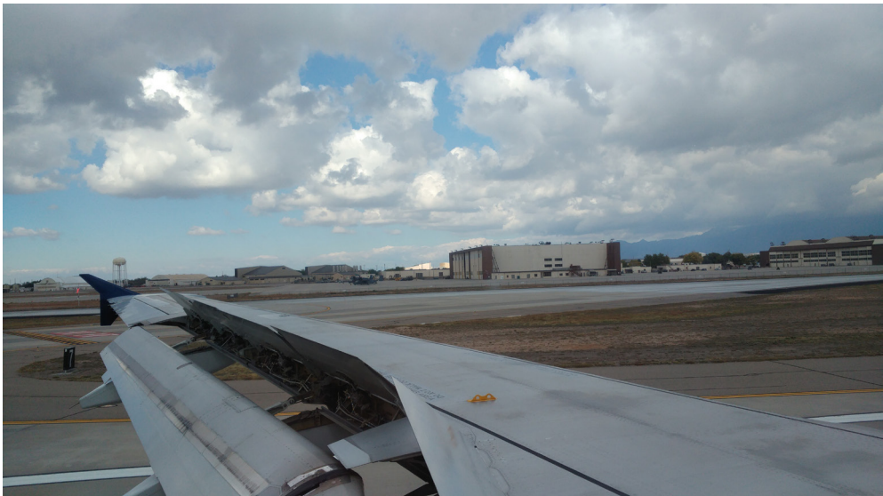
Figura 33: Dispositivos hiper sustentadores (flapes).
