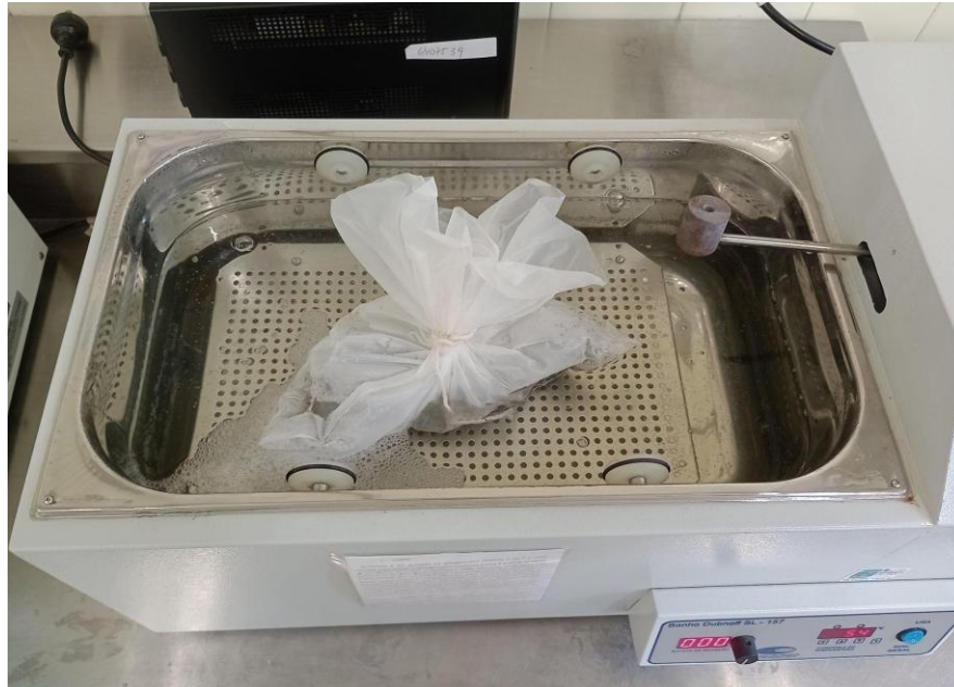
Figura 7 - Tratamento térmico do composto farelado fermentado, por submersão em Banho-Maria aquecido a 50 °C e 80 °C.
