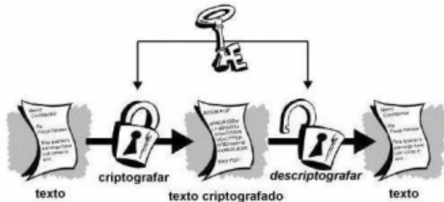
Figura 3.2: Criptografia Convencional ou Criptografia de Chave Simétrica
