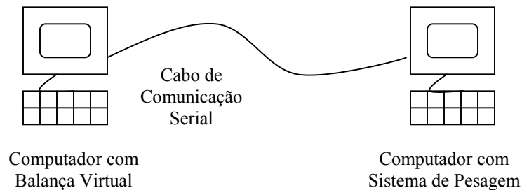
Figura 6: Ilustração do processo de emulação da balança
