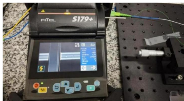
Figura 18 - Máquina de emenda por arco voltaico FITEL S179+ utilizada para a fusão entre as fibras SMF e NCF.
