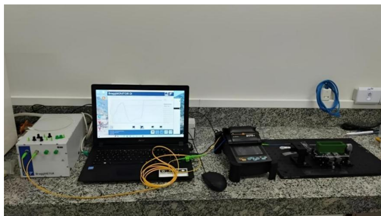
Figura 20 - Configuração Experimental para Interrogação da Estrutura Interferométrica (MMI/SMS/SNCS) (completa)
