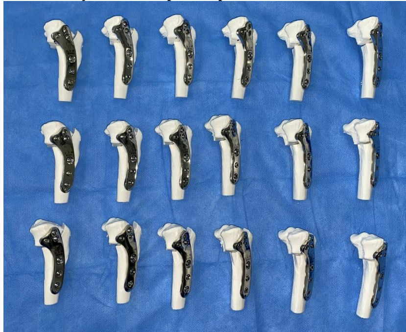
Figura 21 – Imagem fotográfica de espécimes de tíbia de canino impressos em PLA após a realização de TPLO prontos para ensaio biomecânico.
