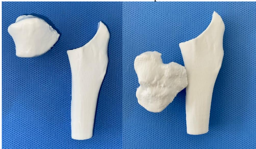
Figura 19 – Imagem fotográfica de espécimes de fragmentos de tíbia impressos em PLA. A: Vista de face medial dos espécimes.; B: Vista dorsal do espécime proximal da tíbia, evidenciando a eminência intercondilar e o epicôndilos tibiais.
