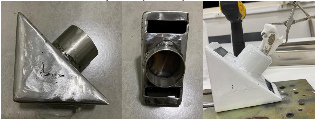
Figura 23 – Imagens fotográficas do aparato desenvolvido para estabilização dos espécimes para o ensaio biomecânico, triângulo retângulo com angulação de 45°, tubo soldado no centro para posterior cimentação de espécime em 135° com a célula de carga e cortes para fixação com parafusos na base da máquina de ensaio biomecânico. A direita observa-se espécime impresso de tibia já inserido para realização da TPLO.
