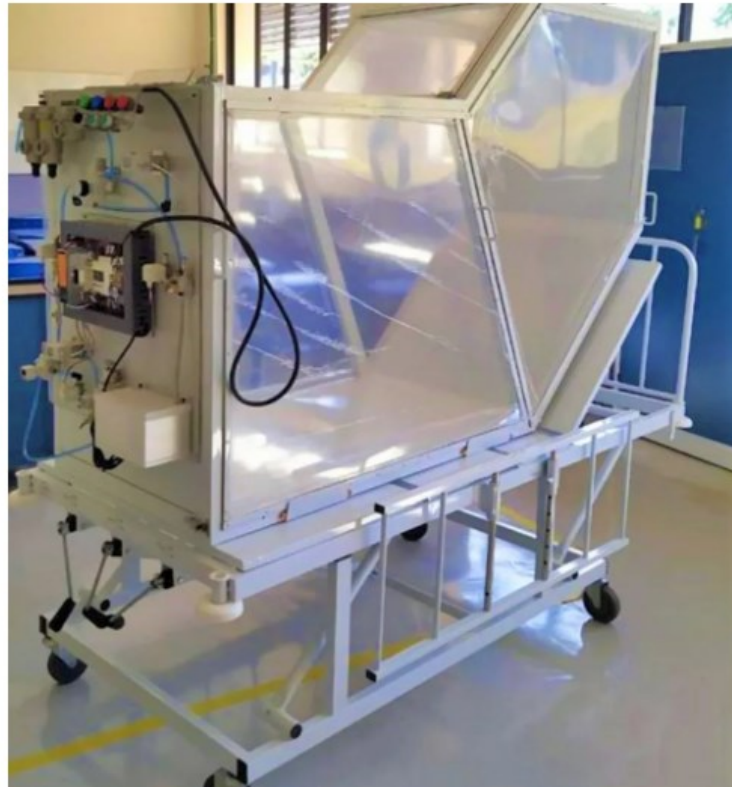
Figura 11 – Prova de conceito para uso em hospitais, para isolar e transportar pessoas portadoras de doenças infectocontagiosas.
