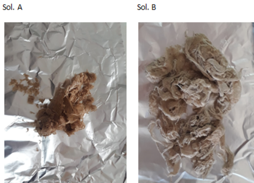
Figura 3.5 – Nanofibras de lignina/PVA prontas para serem termoestabilizadas
