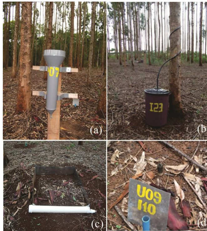
Figura 3 Monitoramento da precipitação interna (a), escoamento pelo tronco (b), escoamento superficial direto (c) e umidade do solo (d) na área experimental
