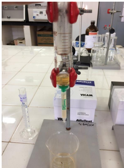
Figura 8. Cromatografia de afinidade para fumonisinas – coluna de imunoafinidade Fumonitest VICAM
