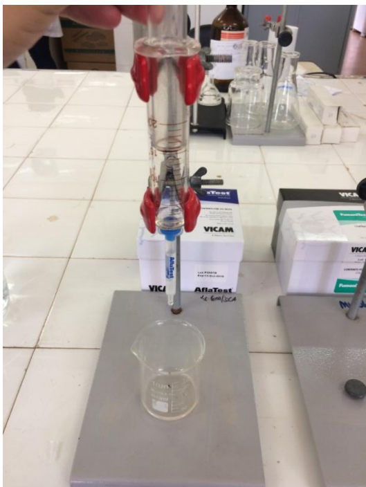
Figura 7. Cromatografia de afinidade para aflatoxinas – coluna de imunoafinidade Aflatest VICAM
