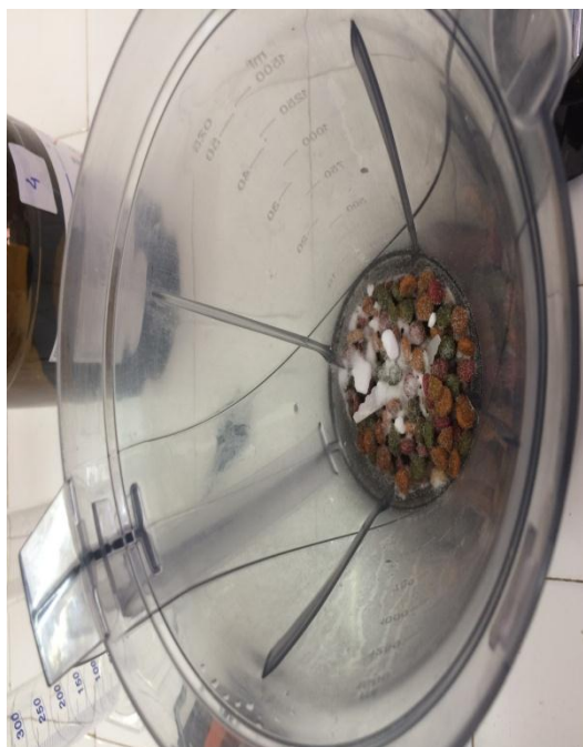
Figura 4. Processamento da amostra com NaCl e solução metanol : água (80 : 20)
