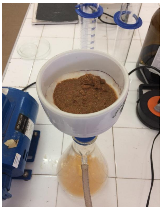
Figura 5. Primeira etapa de filtração em filtro de papel plissado com uso de bomba de pressão negativa
