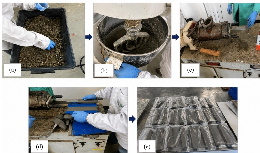
Figura 2 - Processos de produção dos compósitos: (a) mistura manual dos materiais; (b) misturador mecânico dos materiais; (c) máquina extrusora; (d) corpos de prova extrudados; (e) corpos de prova selados a vácuo.
