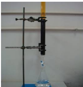
FIGURA 6 Aspecto geral da coluna utilizada para filtragem das cachaças.
