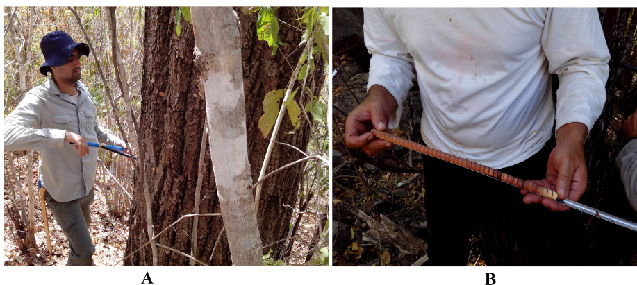
Figura 3.1 – Processo de coleta das amostras de cedro ( Cedrela fissilis ) com o Trado de Pressler. A: Inserção do Trado de Pressler na árvore; B: Retirada da amostra radial com o extrator do Trado de Incremento
