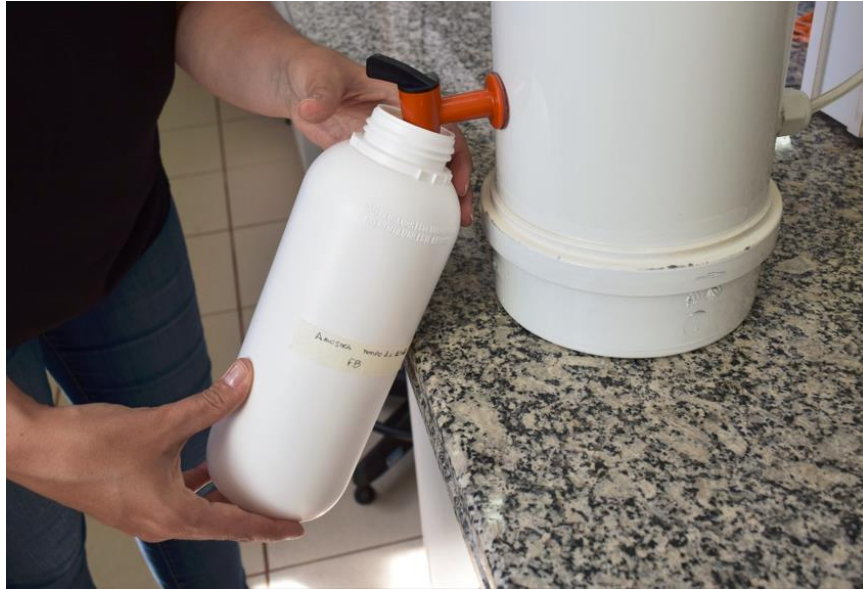
Figura 4.8: Torneira instalada no tanque de reação.
