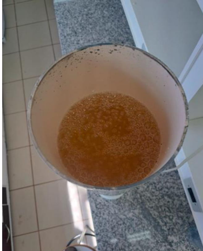
Figura 4.6: Bolhas formadas na amostra durante a ozonização
