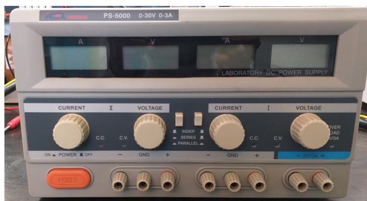
Figura 3.8 – Fonte de alimentação regulável
