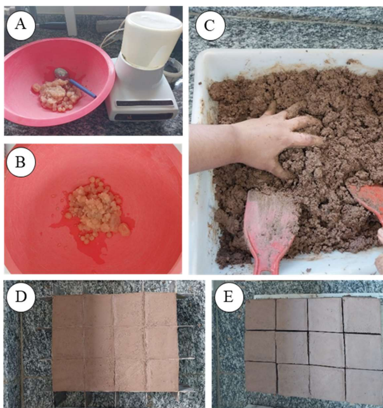
Figura 28 - Processo de produção do adobes.
